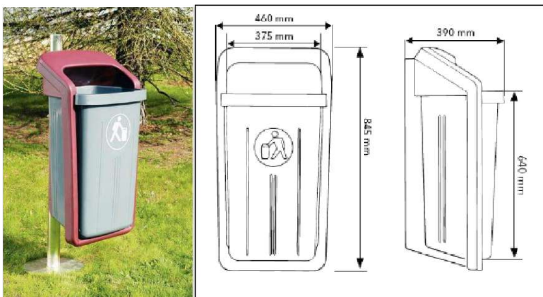
Ilustración 17. Prototipo y planimetría cesta pública tipo México. Capacidad 50 lts, polietileno inyectado de alta densidad.
