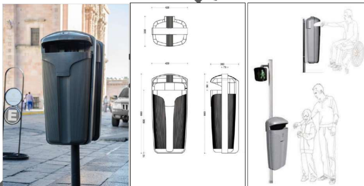
Ilustración 16. Prototipo y planimetría cesta pública tipo Madrid. Capacidad 50 lts, polietileno inyectado de alta densidad, con dispositivo para bolsas, para la recolección de excrementos de mascotas y accesorio para apagar cigarrillos.
